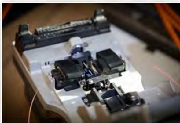
Abb. 2: Einlegen der Fasern in das Spleißgerät
